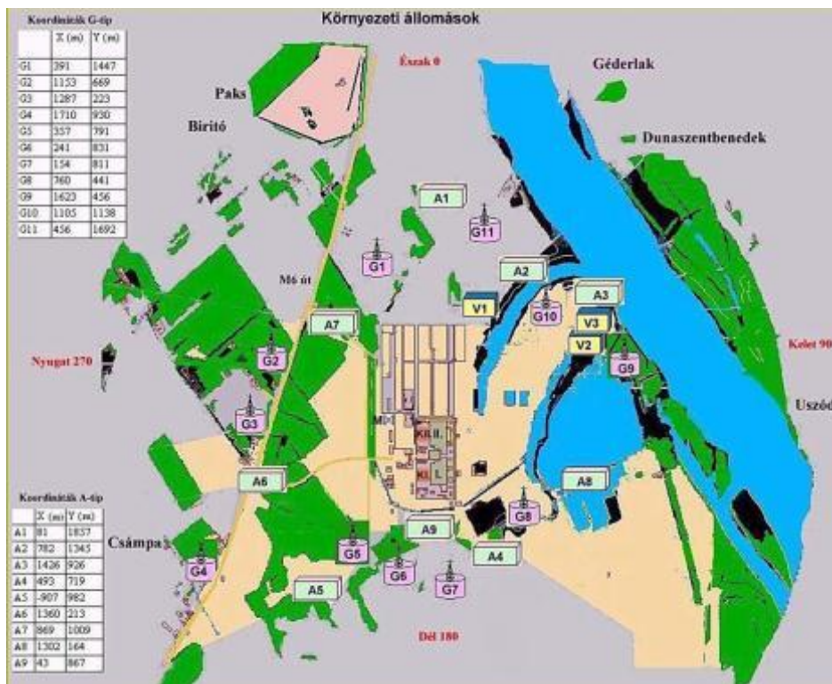
Figura 24: Stațiile de telemetrie de tip „A” și „G” de monitorizare a mediului în apropierea Centralei Nucleare de la Paks [19]
