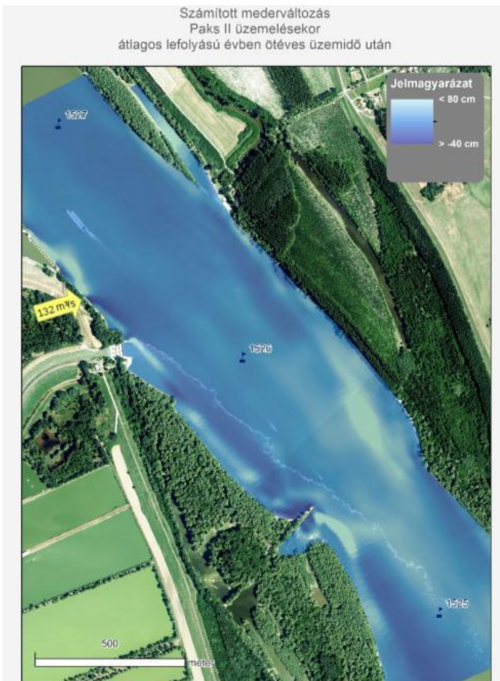
Figura 63: Schimbarea așteptată a albiei, după 5 ani de funcționare, în cazul unui debit al Dunării de 2300 \text{ m}^3/\text{s} (an hidrologic mediu) și extragerii unei cantități de apă de răcire de 100 \text{ m}^3/\text{s} (condiții în perioada 2037-2085) – funcționarea independentă a Centralei Nucleare Paks II (2037-2085)
